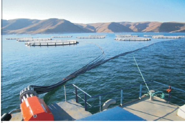
Şekil 9. Otomatik Yemleme Sisteminde Yemlemenin Sağlandığı Borular
